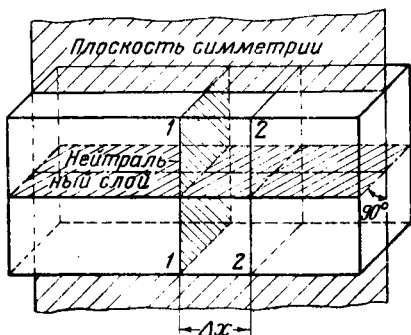
Фиг. 9.2. Плоскость симметрии нейтральный слой балки.
