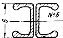
Фиг. 9. 32. К определению допускаемой нагрузки при условии равнопрочности сечений A и C.
